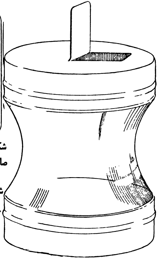
شکل ۱/۵ - دستگاهی که اشکال هندسی حاصل از حباب مابون بین دو حلقه را نشان میدهد .
